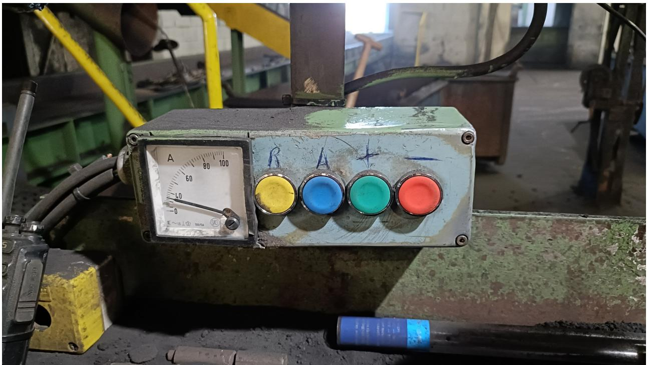
En el exterior también disponemos de botones para controlar el proceso del molino. De izquierda a derecha: Pantalla de configuración, Agua, Humedad + y Humedad -
